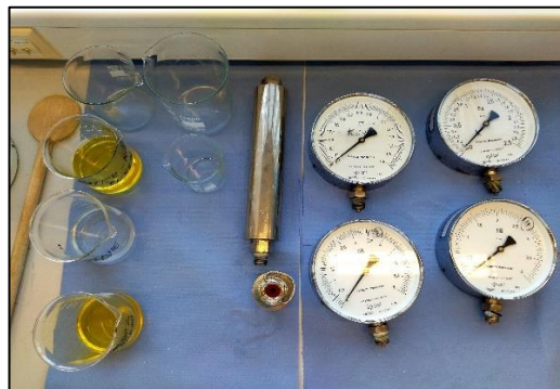
1-2. ábra: anilinpont és gőznyomás mérési elrendezései
