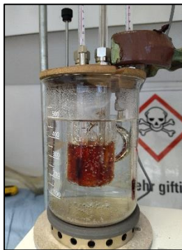
1-2. ábra: anilinpont és gőznyomás mérési elrendezései
